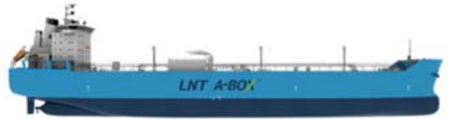
Figure3: 40,000m 3 LNG carrier
