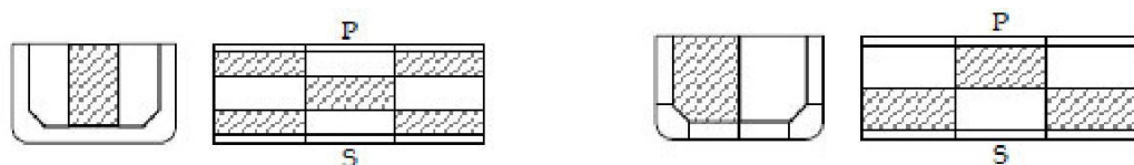
设有两道油密纵舱壁的油船
