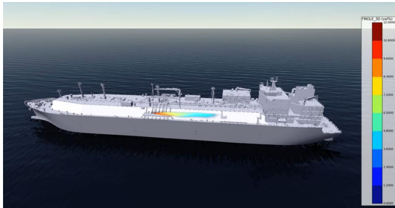
附图 2.6-1 喷射泄漏后的蒸气云扩散
