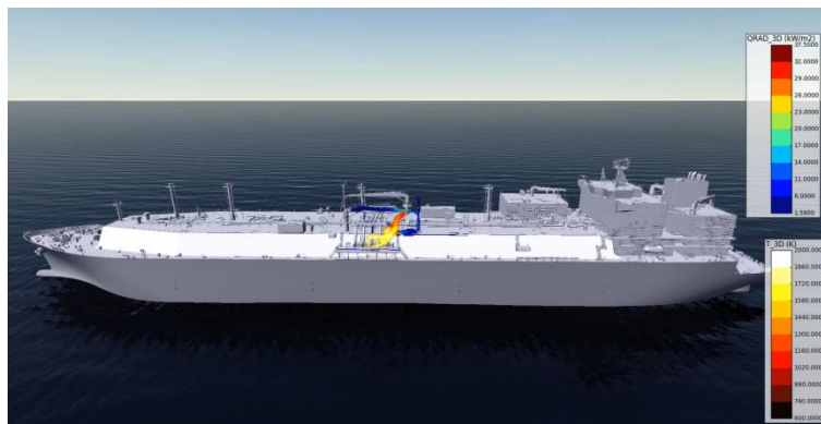
附图 2.6-2 喷射泄漏后的火灾扩散图
