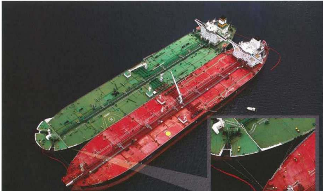
图 1 船对船过驳作业
