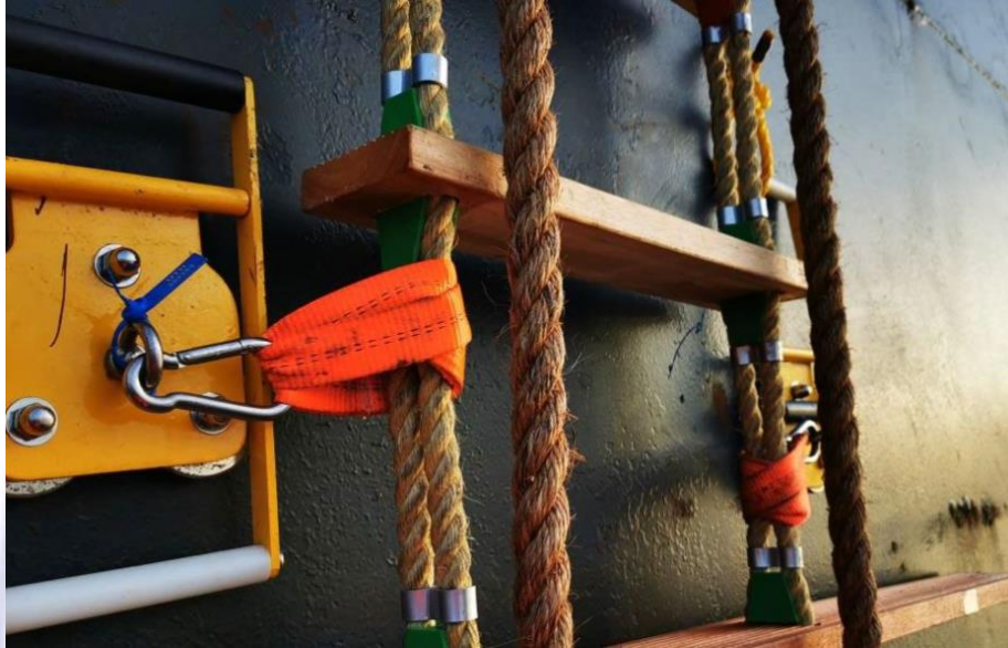
图8 利用磁铁垫固定引水梯和舷梯
