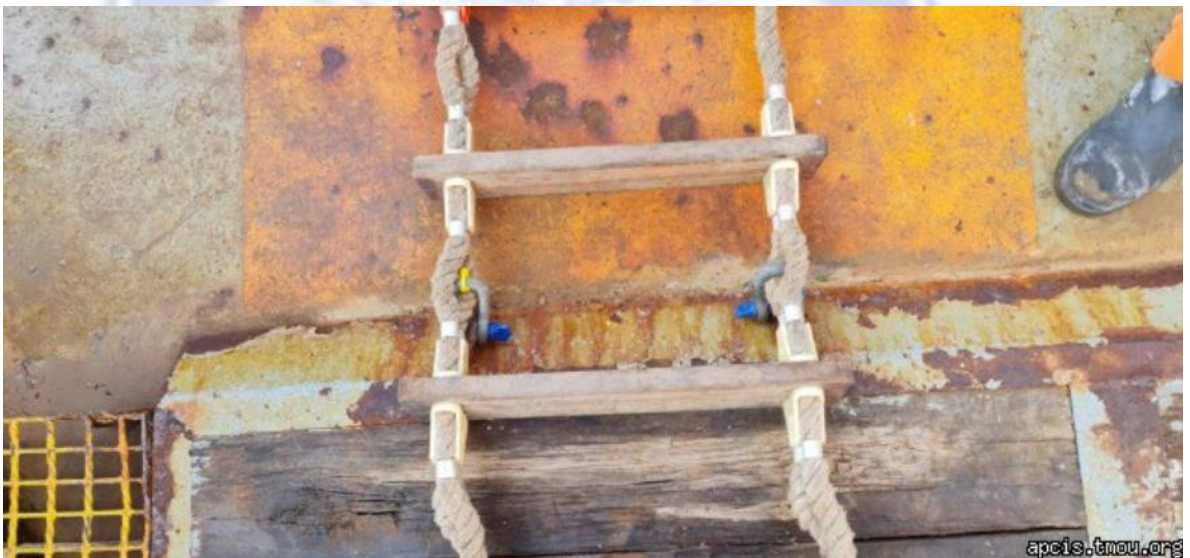
图 14 将引水软梯侧绳索穿过卸扣将其固定的缺陷案例。这种方式加重了单节绳索和绳索固定装置的负荷。
