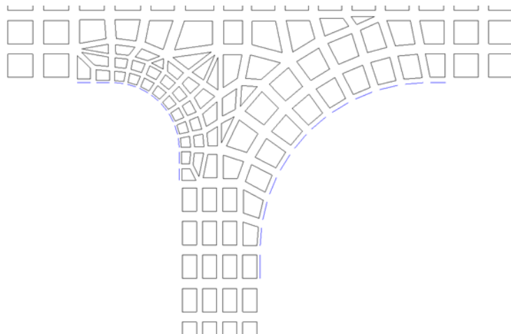
图 3.2.2.2 (2) 开口角隅处的虚拟梁单元
