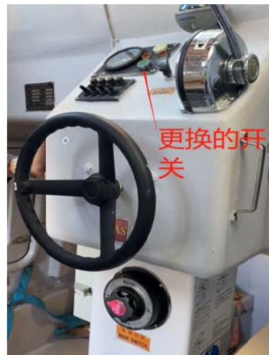
救生艇艇机无法起动
