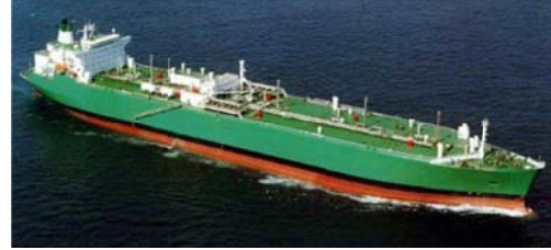
h) LNG 运输船，棱柱形整体甲板
