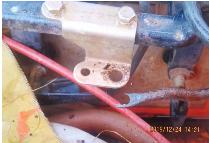
救助艇舵转向杆锈蚀严重
