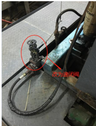
图 6. 隔离装置更换为速闭阀
