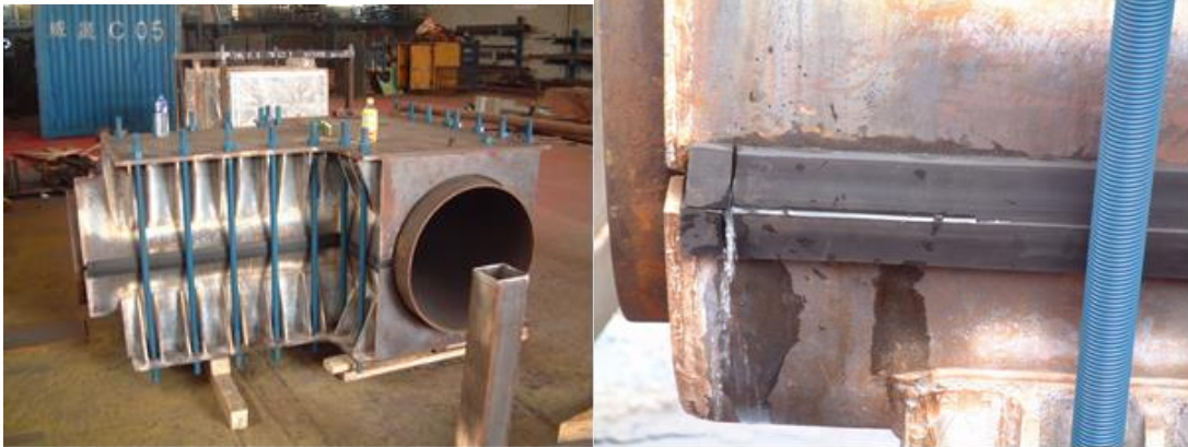
图 1.2.4-2 灌浆卡箍陆上试压
