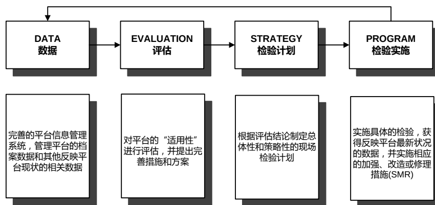
图 2-1 海上移动平台结构完整性管理框架程序
