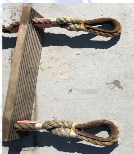
图2 端部套环（护环）腐蚀的示例
