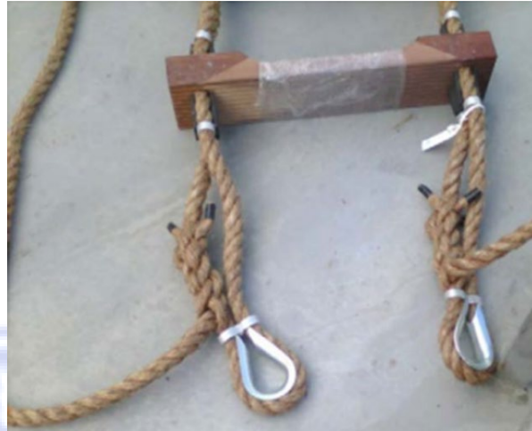
图4 侧绳存在接头（拼接）
