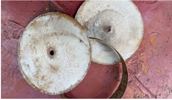
浮盘严重损坏
