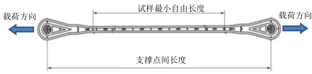
图 4.2.2.2 通用试验设置
